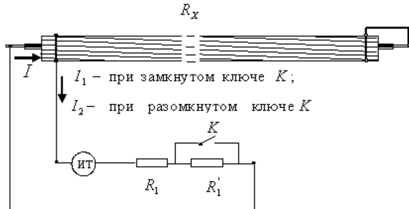
Рис. 3. Способ измерения электрического тока, где ИТ – измеритель тока
