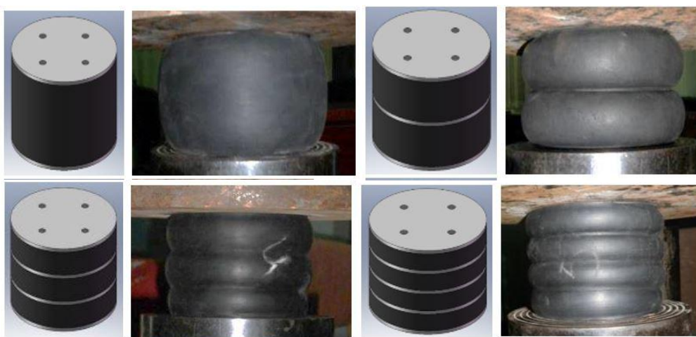
Рисунок 3 – Испытание на сжатие РМО на прессе УМ-100
