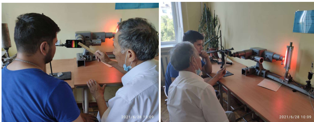
Рисунок 2– Определение постоянной Ридберга группой студентов и синхронными комментариями преподавателя. Это достигается применением смартфона. На мониторе смартфона видно спектр излучения ксенона
