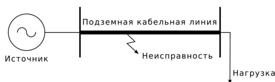
Рисунок 1 – Схема подземной кабельной линии
