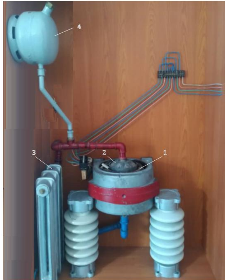
Рисунок 2 – Действующий макет системы отопления на основе электрокотла с индукционным способом нагрева
