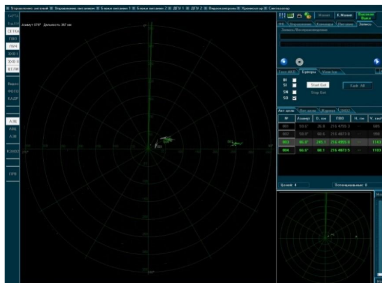
Рисунок 5 – Индикатор радиолокационной станции П-18М с двумя целями
