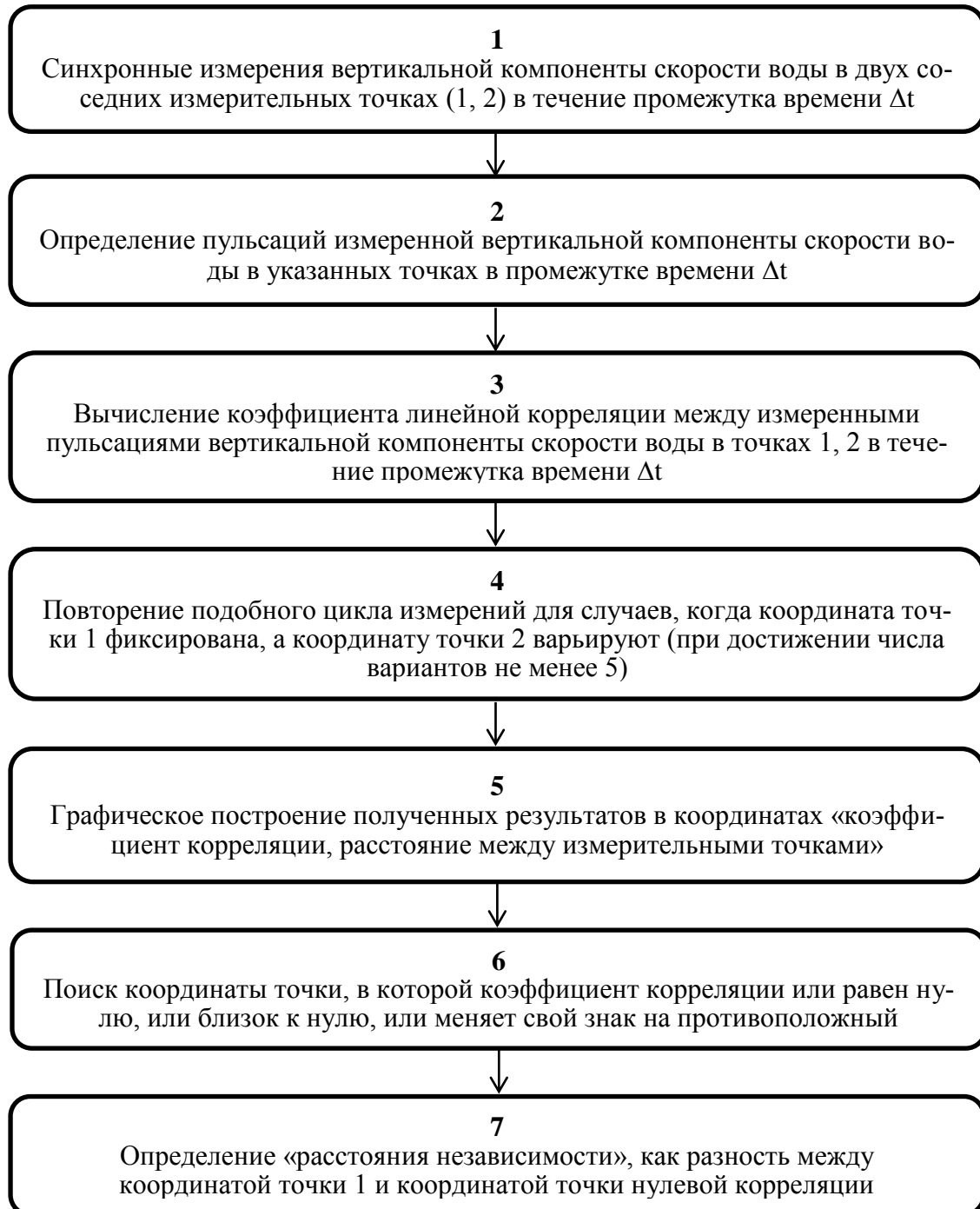
Рисунок – Структурная блок-схема предлагаемого метода определения «расстояния независимости» кинематических характеристик потока воды друг от друга, измеряемых в двух соседних измерительных точках.
