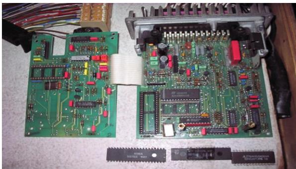
Рисунок 1. Вид двухплатного модуля контроля со сменными чипами
