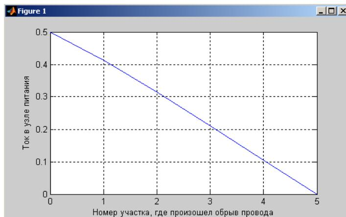
**Рис. 5.** Закон изменения тока  $I_0^1$  при обрыве провода на участках 1 – 5
