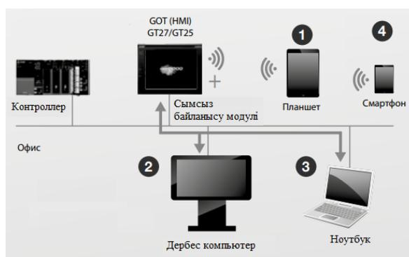
Рисунок 7– Схема подключения к функции GOT mobile
