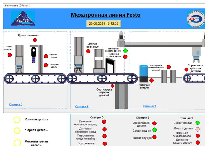
Рисунок 5 – SCADA-система для станда «Мехатронная линия FESTO»
