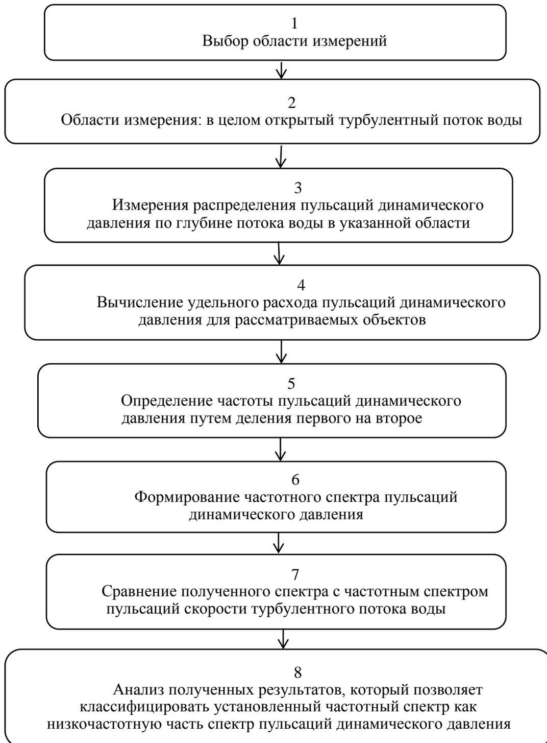
Рисунок 4 – Структурная блок-схема метода определения частотного спектра пульсаций динамического давления в открытом турбулентном потоке воды.
