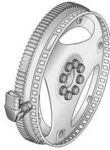
Рисунок 1 – Индуктивный датчик положения коленчатого вала ДВС и зубчатое колесо
