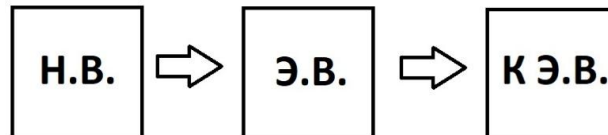
Рисунок 1 – Принципиальная схема усиления сигнала в АЦП (Н.В – неэлектрическая величина, Э.В. – электрическая величина, К – коэффициент масштабирования)
