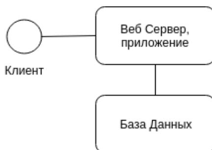
Рисунок 1 – Пример с переносом сервера баз данных на отдельный сервер
