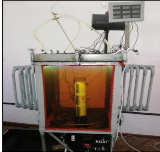
Рисунок 3 – Физическая модель силового масляного трансформатора
