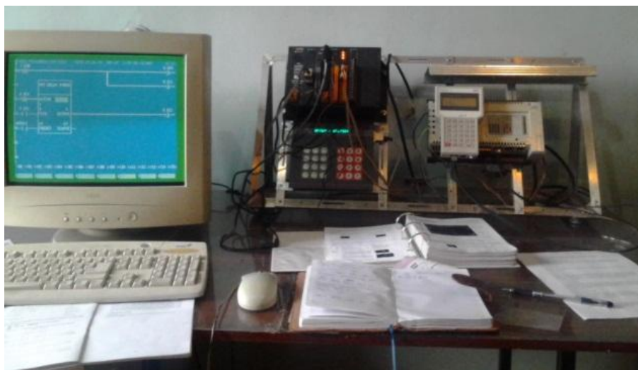
Рисунок 8 – Подсистема локальной автоматизации с ПЛК и ПК.
