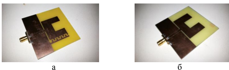
Рисунок 12 – а – U-образная микрополосковая антенна с метаматериалом; б – U-образная микрополосковая антенна.
