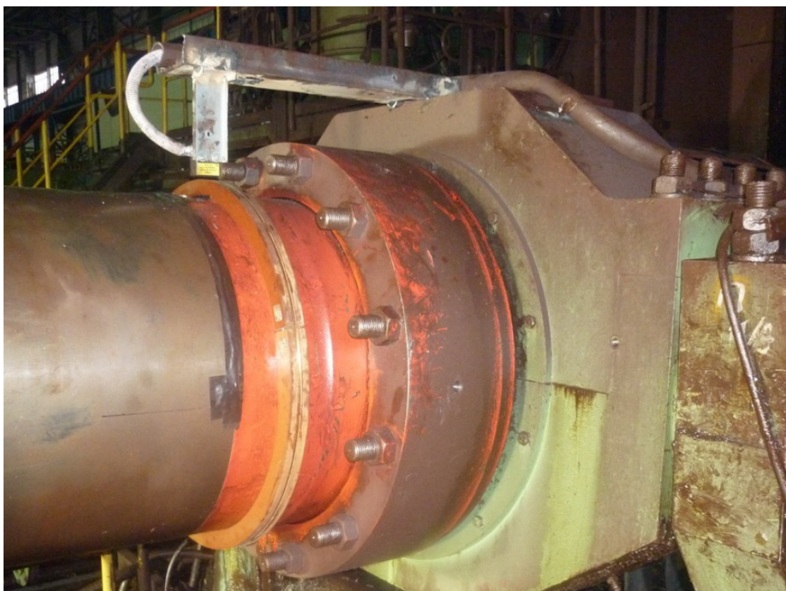
Рисунок 4 – Расположение телеметрического кольца на шпинделе верхнего валка горизонтальной клетки
