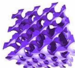
Рисунок 6 – Кристалл с заполненной фотонной щелью
