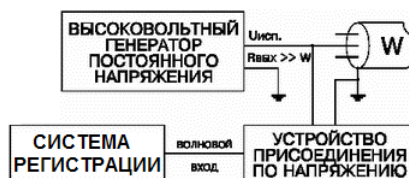
Рисунок 6 – Структурная схема реализации волнового метода бегущей волны напряжения
