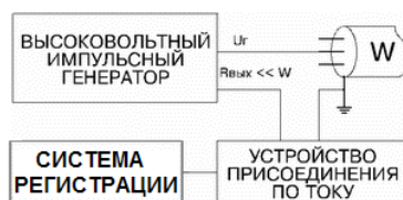
Рисунок 8 – Структурная схема устройств для осуществления волнового метода импульсного тока
