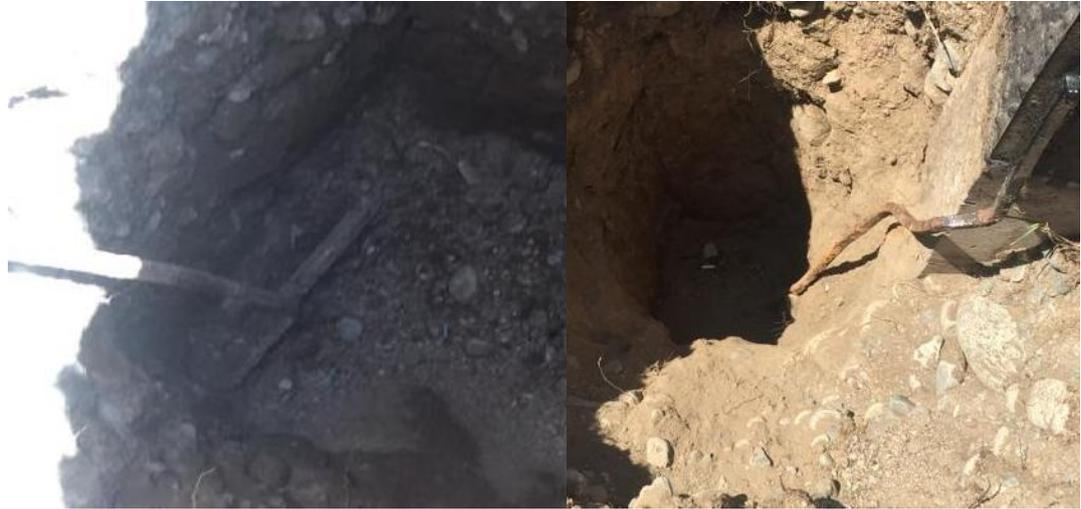
Рисунок 3 – Коррозийное состояние заземлителей
