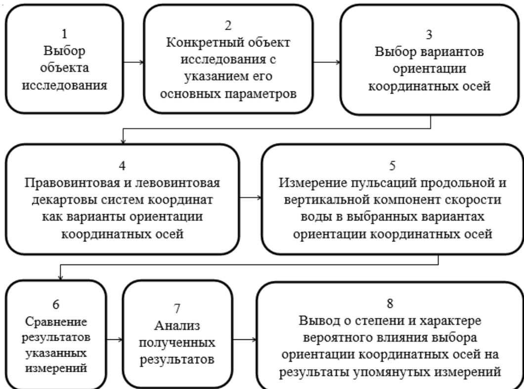
Рисунок 3 – Структурная блок-схема реализации метода установления вероятного влияния выбора ориентации координатных осей на результаты измерений кинематических характеристик открытого турбулентного потока воды
