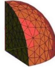
Рисунок 3 – Принцип эквивалентных объемов (тетраэдральная сетка разбиения)
