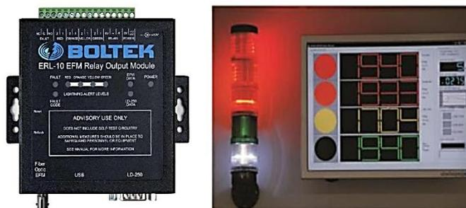
Рисунок 10 – Внешний вид и демонстрация работы вспомогательного модуля ERL-10
