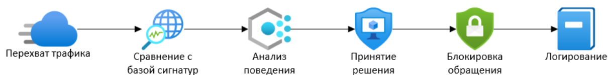
Рисунок 8 — Сетевая система предотвращения вторжений
