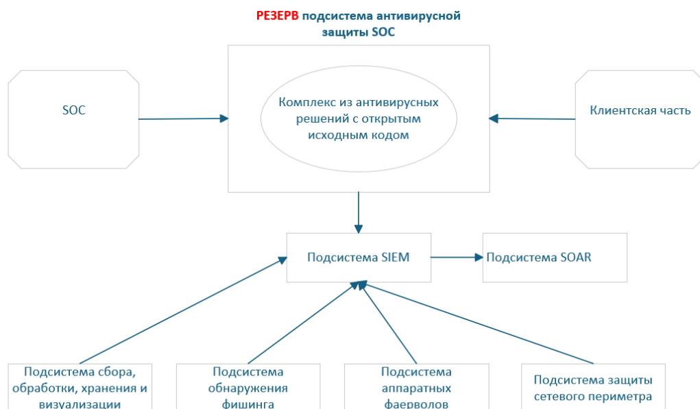
Рисунок 7— Структурная схема подсистемы антивирусной защиты с использованием резервной подсистемы
