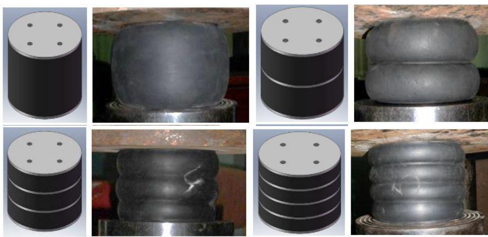
Рисунок 3 – Испытание на сжатие РМО на прессе УМ-100
