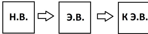
Рисунок 1 – Принципиальная схема усиления сигнала в АЦП (Н.В – неэлектрическая величина, Э.В. – электрическая величина, К – коэффициент масштабирования)
