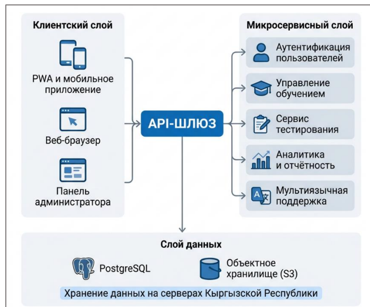
Рисунок 4 – Микросервисная архитектура цифровой образовательной платформы
