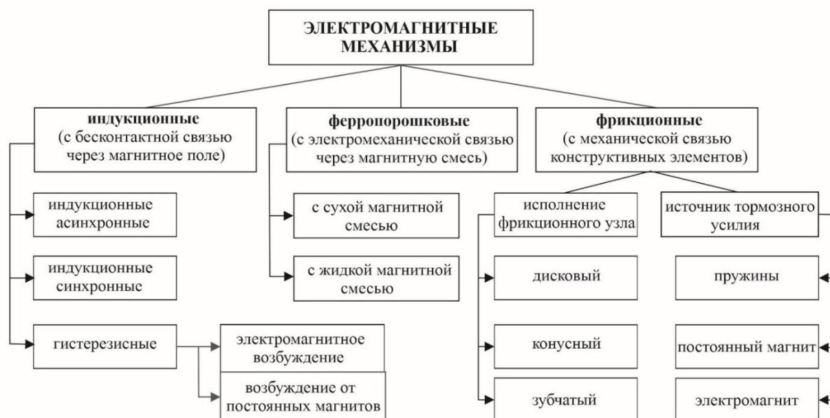
Рисунок 1 – Классификация ЭММ по виду связи между их ведущей и ведомой частями
